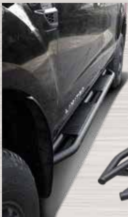
Art. 29206 Schwellerrohre „Black Stealth“ Ø 50 mm Passend nur für Doppelkabine Ford Ranger (2012-2018) & (2019-2022) Ford Ranger Raptor (2019-2022)
